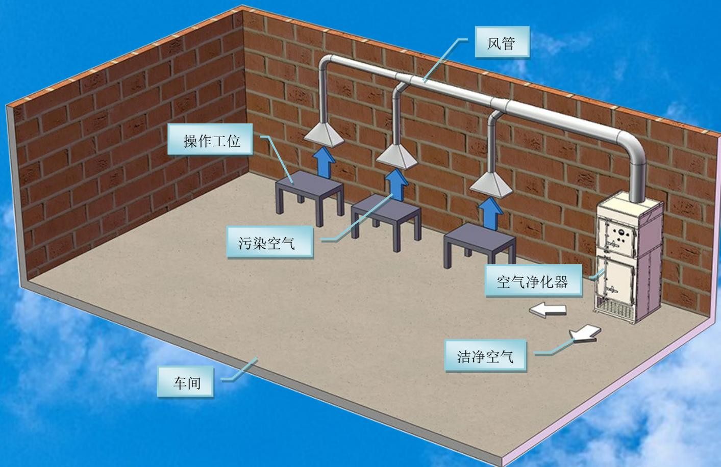
模式三：风管吸入污染空气，洁净空气室内循环
