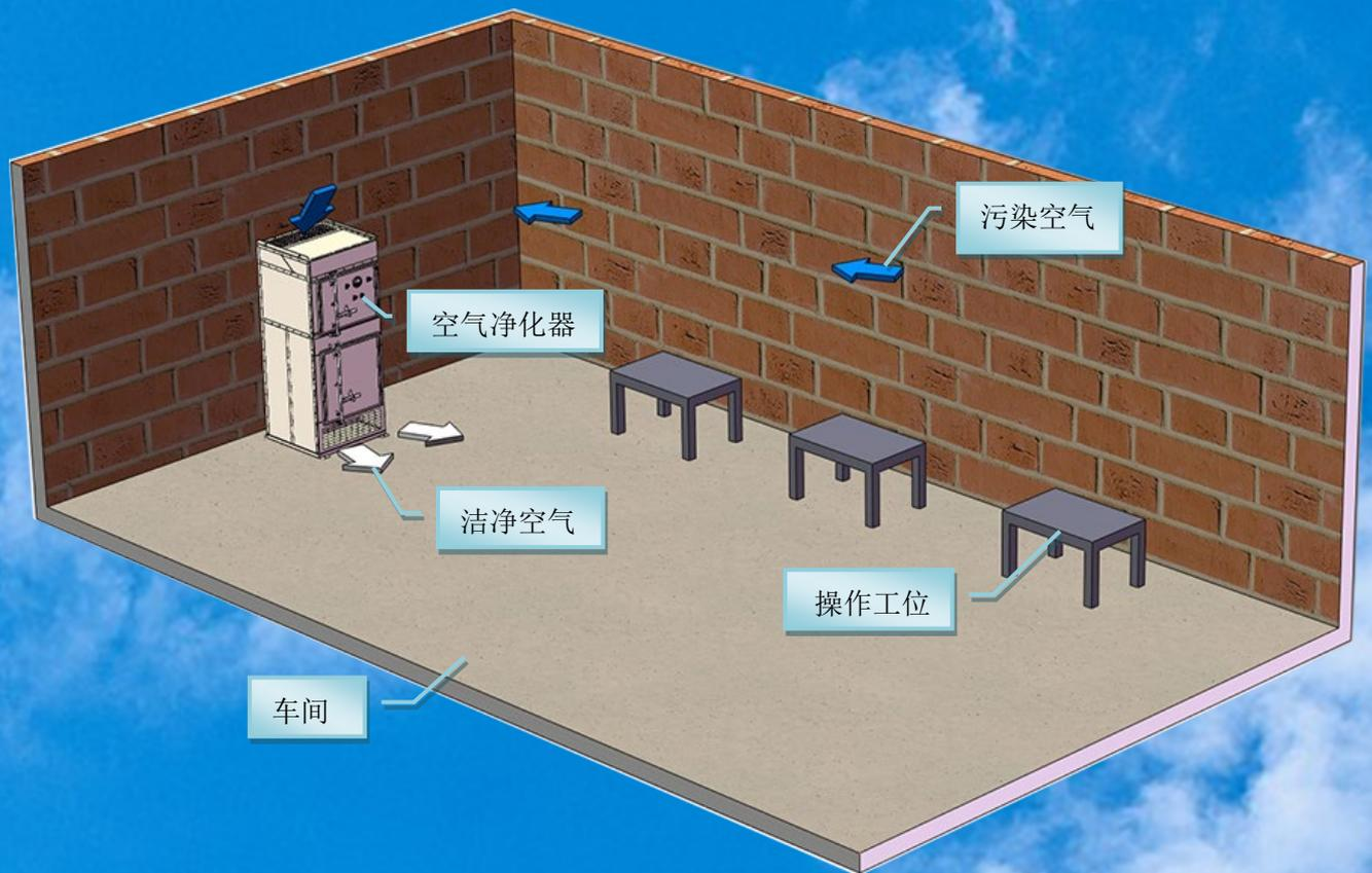
模式一：设备顶部吸入污染空气，洁净空气室内循环
