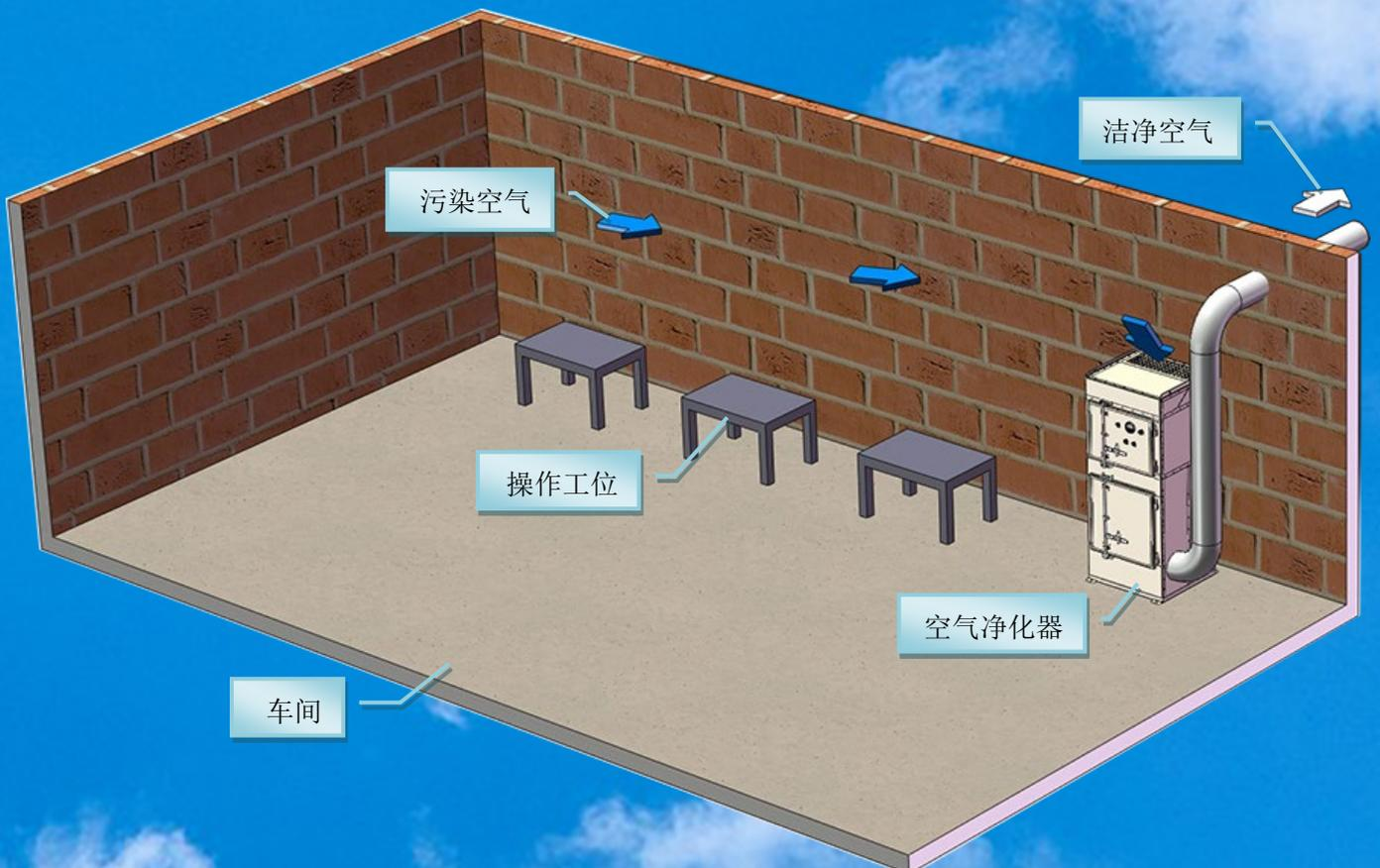
模式二：设备顶部吸入污染空气，洁净空气排出室外
